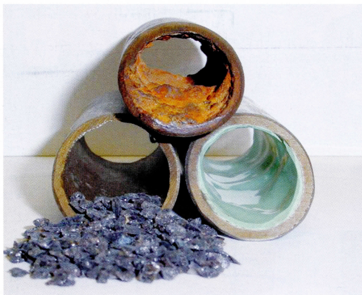
Der Unterschied zwischen unbehandelten und gereinigten Rohren ist nicht zu übersehen. Das Bild zeigt ein unbehandeltes, ein gestrahltes und ein beschichtetes Rohr.
